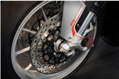
Sistema de freno con función anti lift-up
